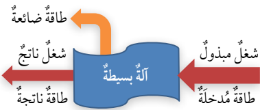
الشكل (14): تحولات الطاقة في الآلة البسيطة.
