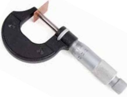
الشكل (3): قياس سُمْكِ صفيحة باستخدام الميكروميتر.
